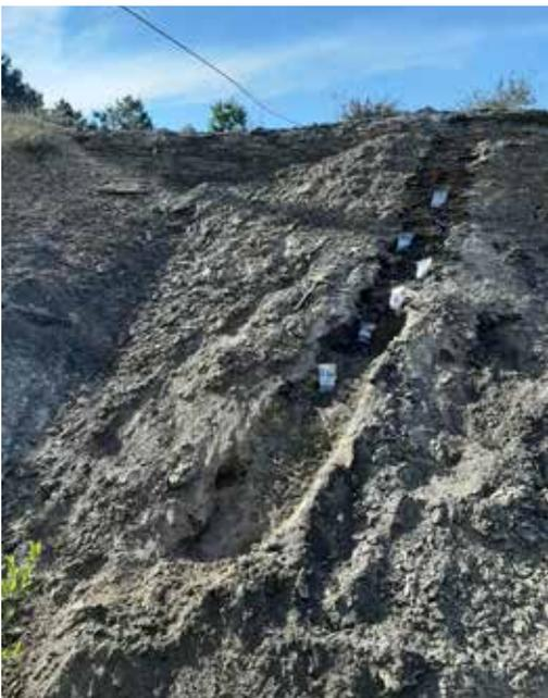
Muestreo palinológico en lutitas oscuras correspondiente a la parte superior de la Formación Escucha.
